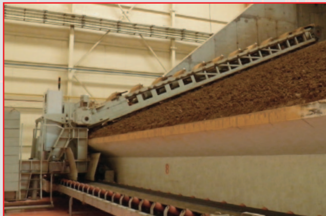
LBV EXCAVADORA LONGITUDINAL
