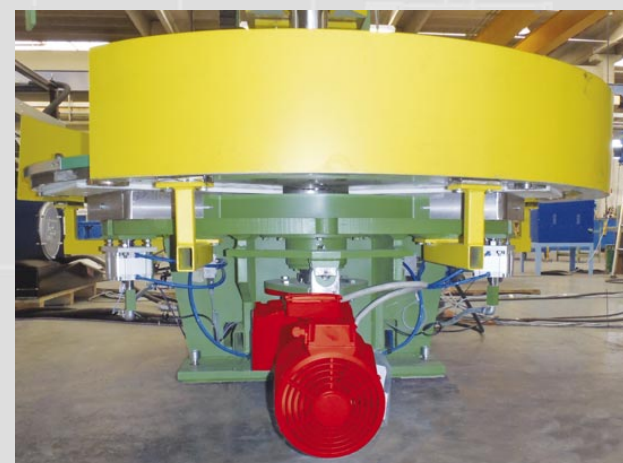
Servomoteur pour la rotation de la table
