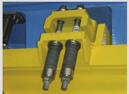
Pré-tension pour le rouleau de levage
