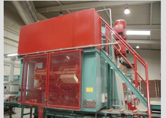
Les presses DR6 disposent d'une plateforme supérieure pour chaque équipement auxiliaire tel que le groupe hydraulique ou les pompes à vide.
