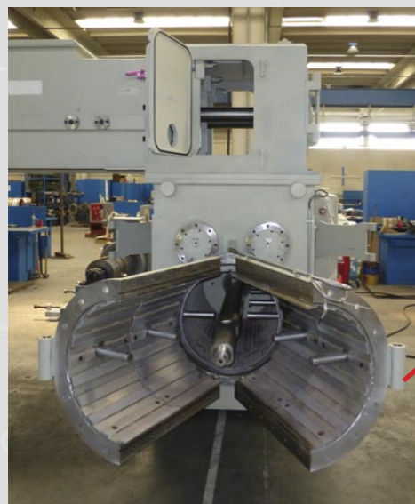
Zylinderverlängerung für Wartungszwecke leicht zu öffnen
