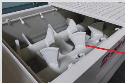
Mischer mit Mischpaddel, Gegenmesser und integrierter Bewässerung
