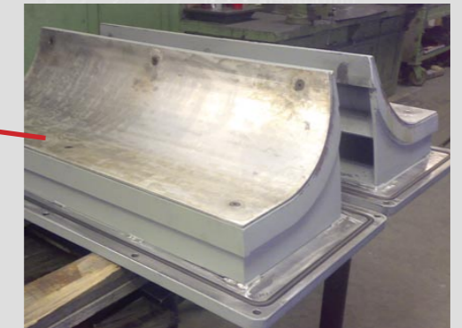
Austauschbare Futterbleche im Bereich der Speisepaddeln
