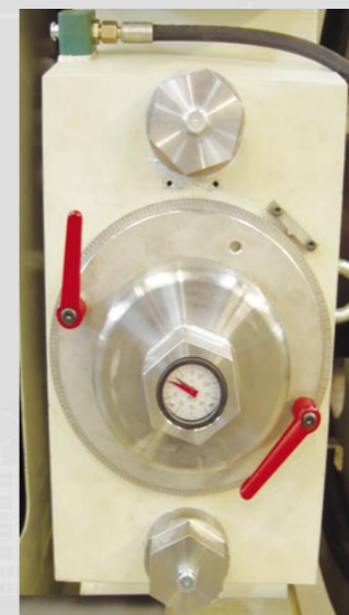
Réglage mécanique de l'écartement des cylindres
