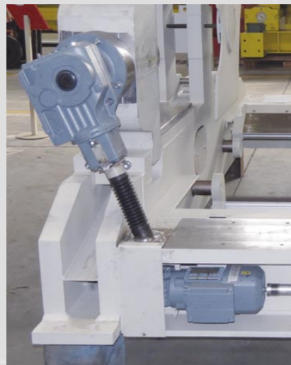
Réglage électromécanique de l'écartement des cylindres
