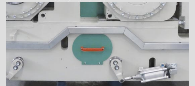
Ouverture pour remplacement du racloir
