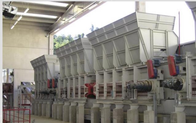
Tutte le macchine di queste serie sono dotate di variatore di velocità sul motore principale e consentono così una regolazione fine della produttività. Gli aspi di alimentazione, montati su un albero azionato indipendentemente, regolabili orizzontalmente, assicurano l'uniformità dell'alimentazione dell'argilla. Diverse tipologie di aspi rendono possibile un dosaggio ideale della materia prima trattata.
